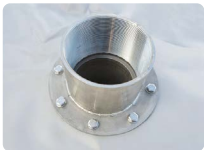
10 - FIXER LE BLOC BRIDE EN EFFECTUANT UN SERRAGE EN CROIX, AMENER CHAQUE VIS AU BLOCAGE SANS FORCER
