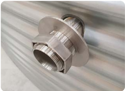
2 - ENFILER UNE RONDELLE ET L'ECROU A L'EXTERIEUR DE LA CITERNE NE PAS BLOQUER L'ECROU AVANT LA POSE DU COUDE PVC
