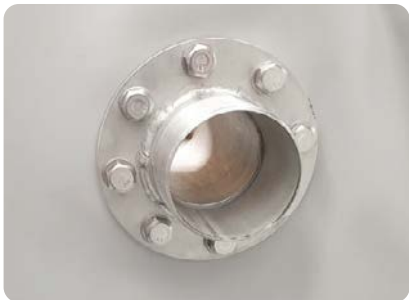
9 - FIXER LE BLOC BRIDE EN EFFECTUANT UN SERRAGE EN CROIX, AMENER CHAQUE VIS AU BLOCAGE SANS FORCER
