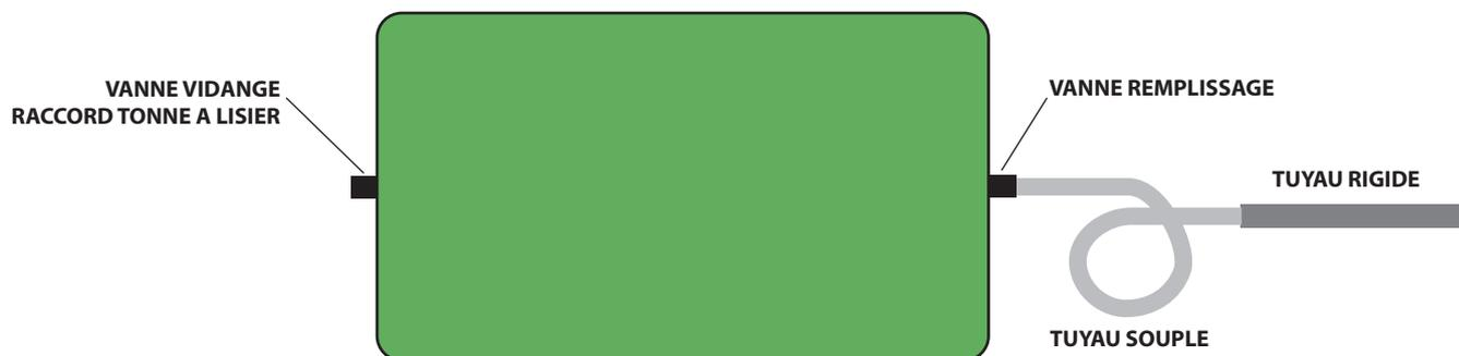
**LE RACCORD FINAL ENTRE LE TUYAU RIGIDE ET LA VANNE DE REPLISSAGE S'EFFECTUE AVEC UN TUYAU SOUPLE
