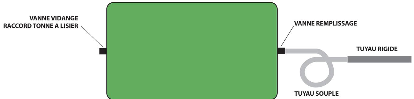
**LE RACCORD FINAL ENTRE LE TUYAU RIGIDE ET LA VANNE DE REPLISSAGE S'EFFECTUE AVEC UN TUYAU SOUPLE
