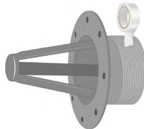
Vissez le raccord symétrique **SANS TENONS** sur la vanne.
