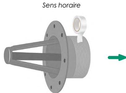
Vissez le raccord symétrique **SANS TENONS** sur la vanne.
