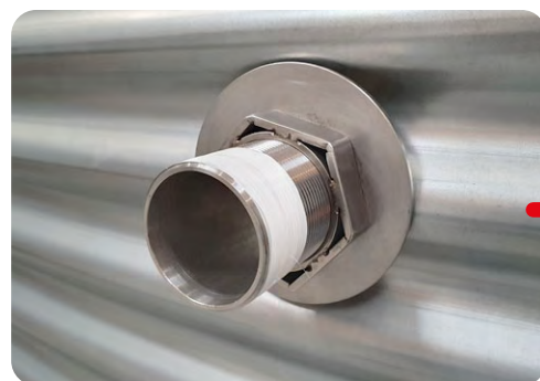
Poser du téflon sur le filetage (sens horaire) avant de visser le coude PVC.
