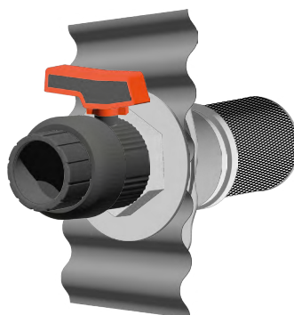
Vidange par le côté Vanne 1/4 de tour PVC DN50 Traversée de cloison INOX Crépine INOX
